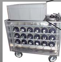
Zusatzbeladung für GW-L1: Transportwagen mit Atemluftflaschen + Kiste mit Lungenautomaten und Helmlampen + Kiste mit Ersatzakku und Ladegeräte für 0,7 m Funk + Mineralwasser + Schnelleinsatzzelt
